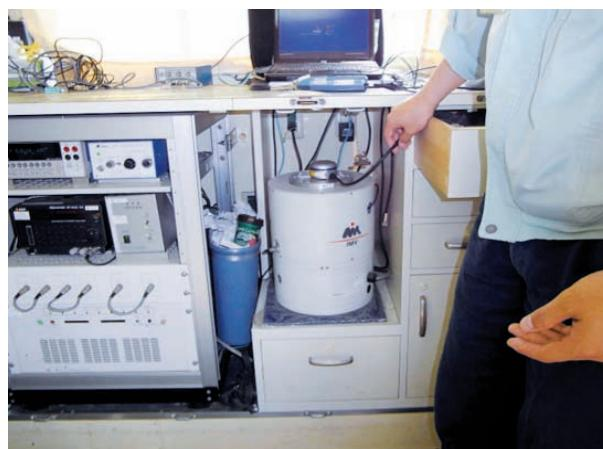
【振動計の計量証明検査】
